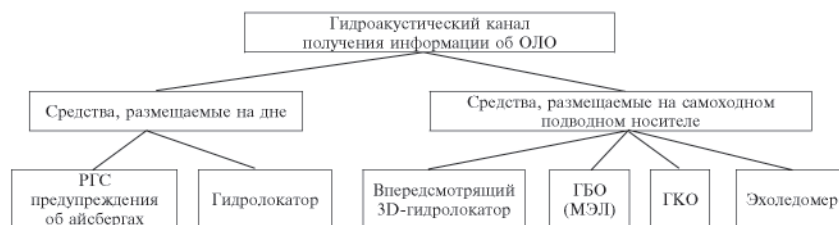
Рис. 7. Состав средств гидроакустического канала получения информации об ОЛО
